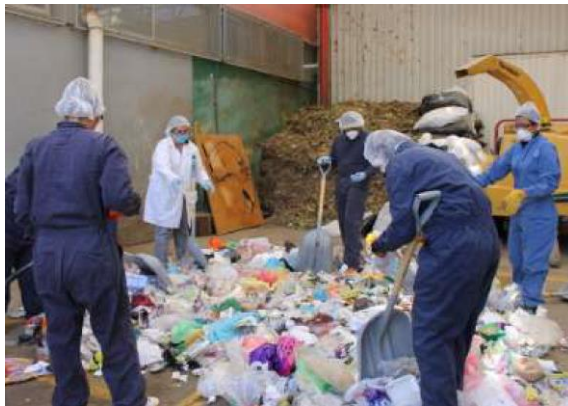
IMAGEN 1. MUESTREO POR EL MÉTODO DE CUARTEO, PARA LA OBTENCIÓN DE MUESTRA.
